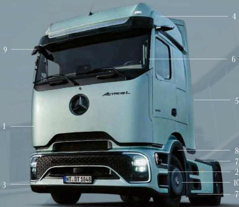
1. Neue verlängerte aerodynamische Front & Stoßfänger und verschiedene Abdichtungen für optimierten Luftstrom
